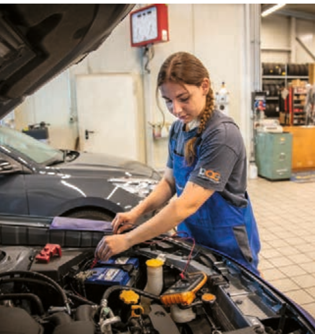
^ Le multimètre permet de mesurer la tension électrique d'un moteur, par exemple.
